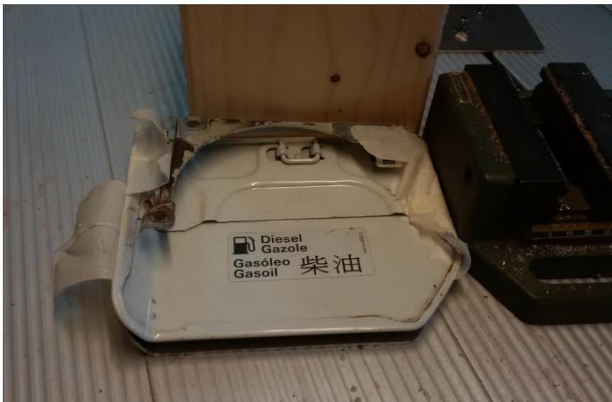
Farbmarkierung durch leichten Druck auf den Tankdeckel übertragen
